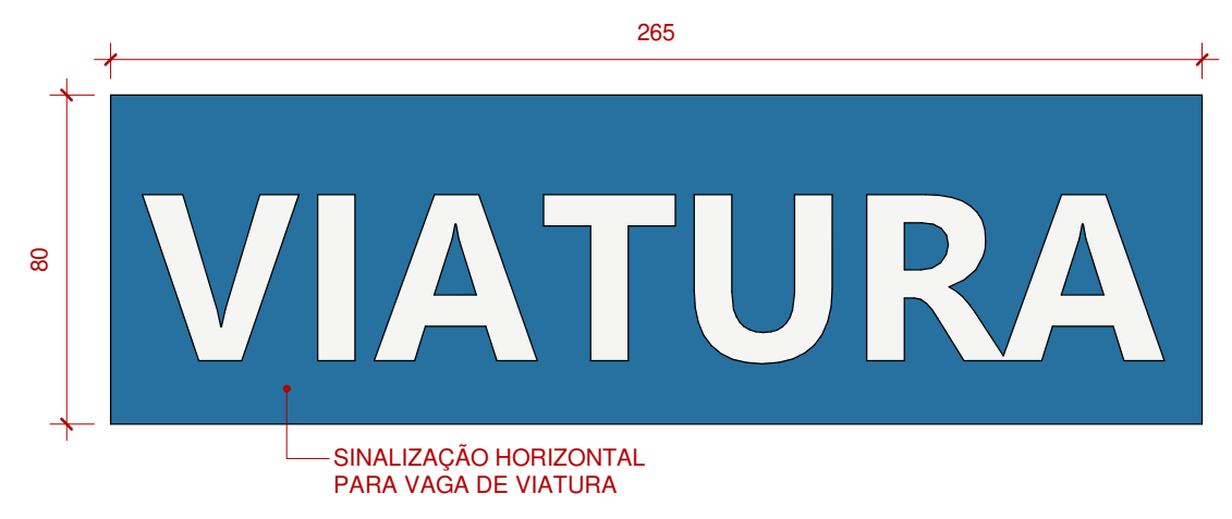
6 DETALHE DE PINTURA - VIATURA 1 : 20
